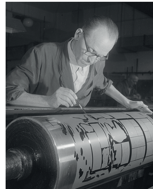
Tiefdruckzylinder der VEB Typoart Dresden bei der Abdekarbeit an einem Kupferzylinder
